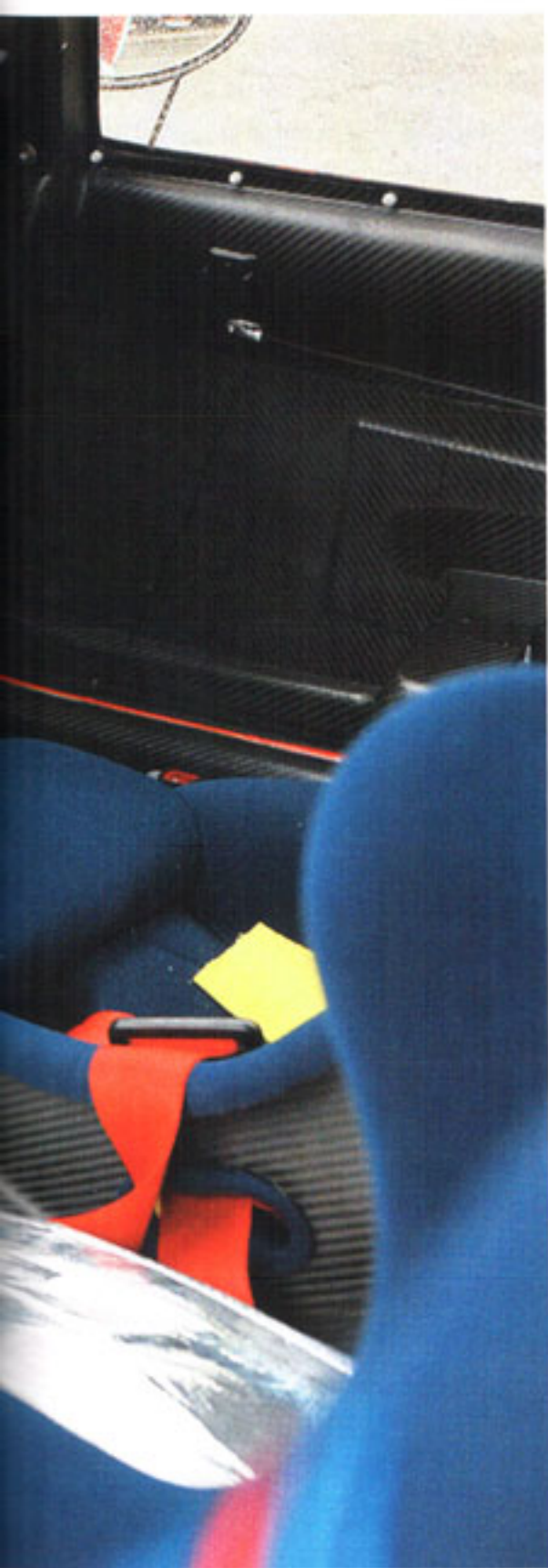
L'abitacolo della vettura. A sinistra una vista totale con, sopra la bombola del liquido estinguente, il cruscotto digitale Magneti Marelli. Sopra una vista laterale: dietro al sedile del pilota trova posto la centralina elettronica, anch'essa della Magneti Marelli. Sotto la strumentazione piazzata dietro al volante, a destra gli interruttori per gestire le mappature della centralina e l'overboost del turbo.
