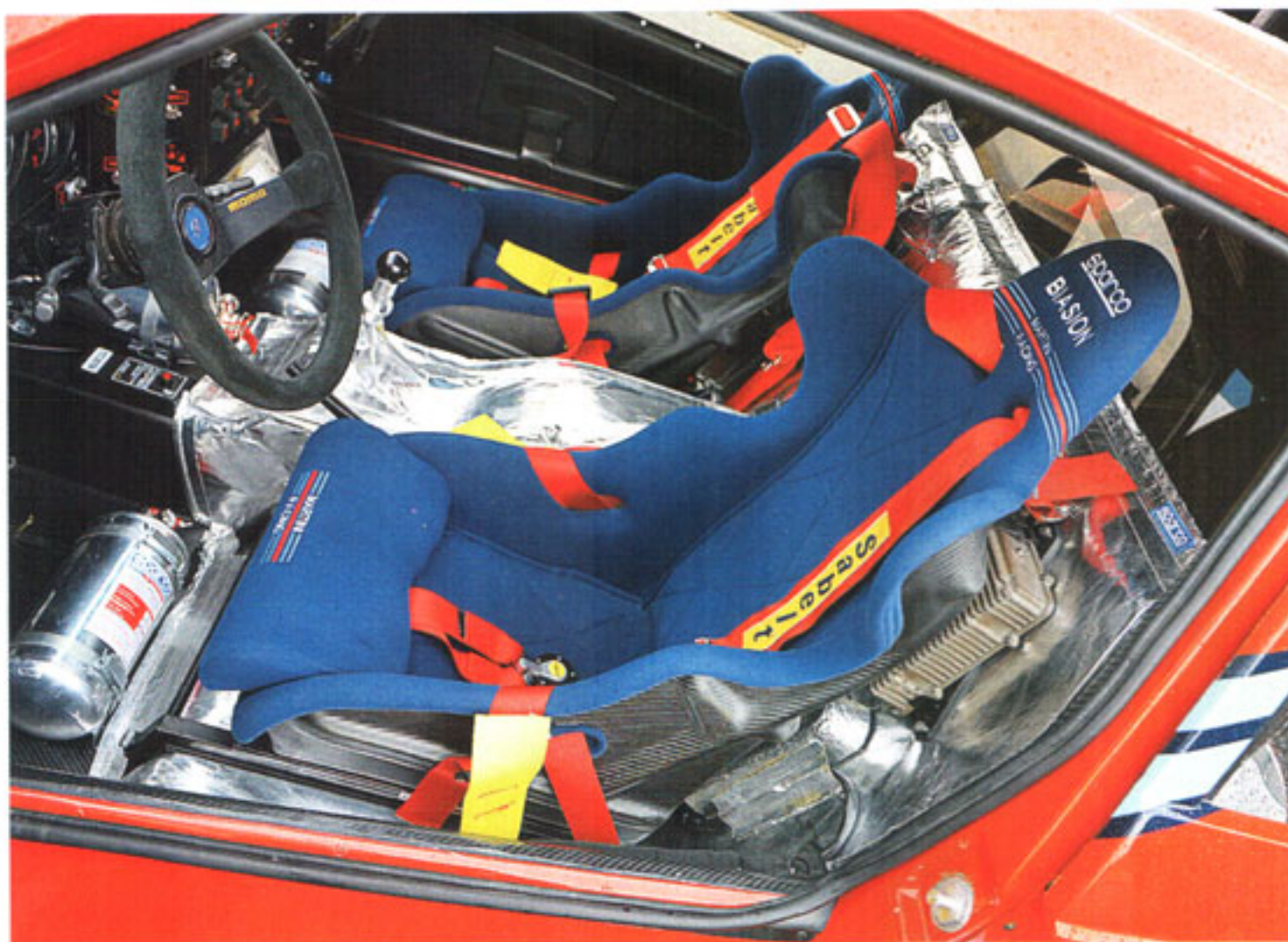
L'abitacolo della vettura. A sinistra una vista totale con, sopra la bombola del liquido estinguente, il cruscotto digitale Magneti Marelli. Sopra una vista laterale: dietro al sedile del pilota trova posto la centralina elettronica, anch'essa della Magneti Marelli. Sotto la strumentazione piazzata dietro al volante, a destra gli interruttori per gestire le mappature della centralina e l'overboost del turbo.
