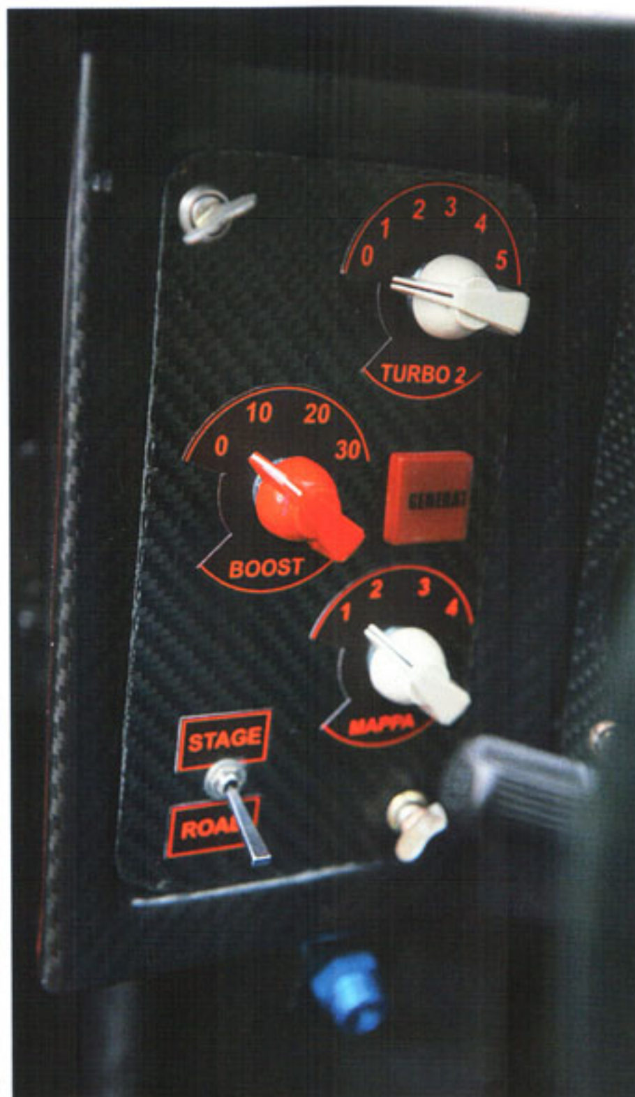
L'abitacolo della vettura. A sinistra una vista totale con, sopra la bombola del liquido estinguente, il cruscotto digitale Magneti Marelli. Sopra una vista laterale: dietro al sedile del pilota trova posto la centralina elettronica, anch'essa della Magneti Marelli. Sotto la strumentazione piazzata dietro al volante, a destra gli interruttori per gestire le mappature della centralina e l'overboost del turbo.
